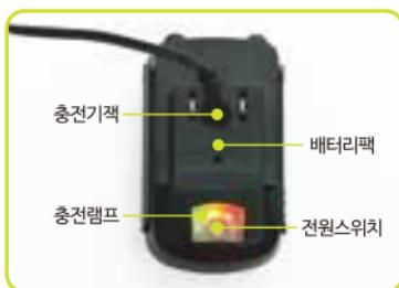
▪ 배터리를 충전하려면 충전기 채크를 배터리에 삽입하고, 충전기를 콘센트에 연결하세요.
